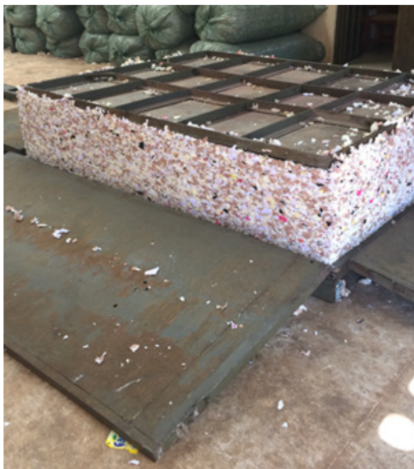
Figura 22 – Bloco de AG sendo desmoldado
