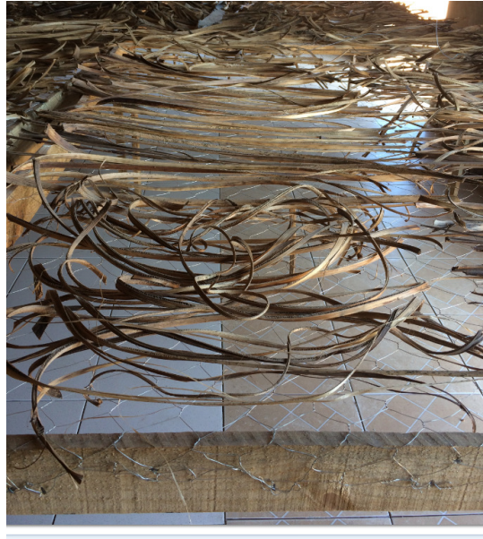
Figura 24 – Fibras de bananeira desfiadas distribuídas no secador
