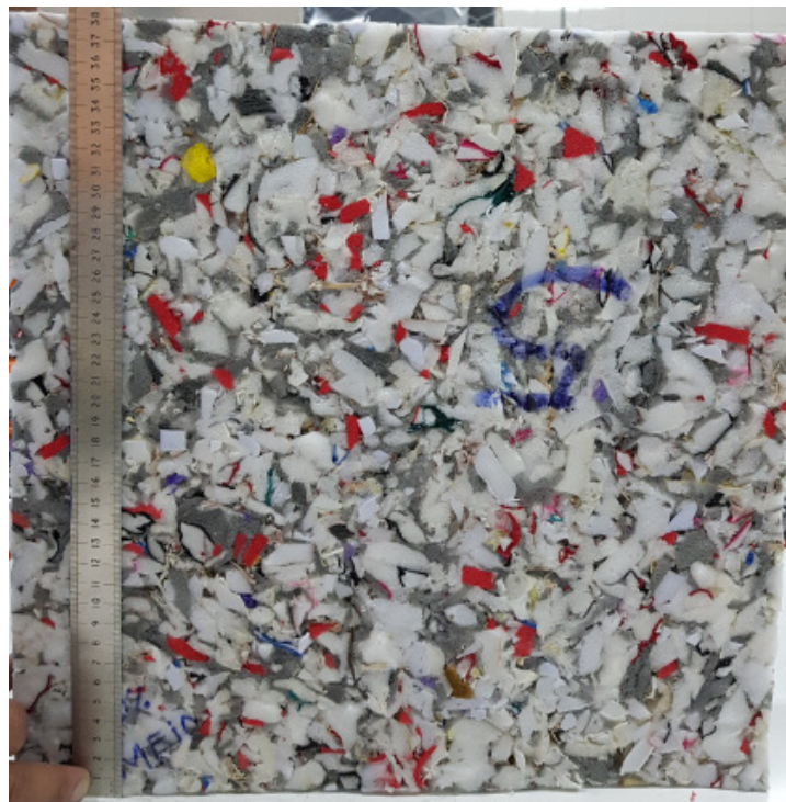
Figura 33 – AGFB 4- 10% de fibra, espuma flexível de PU e aparas têxteis
