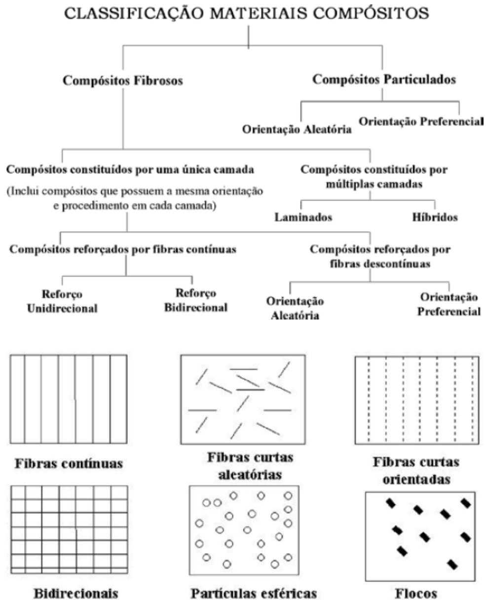
Figura 15 – Classificação de compósitos de acordo com o reforço
