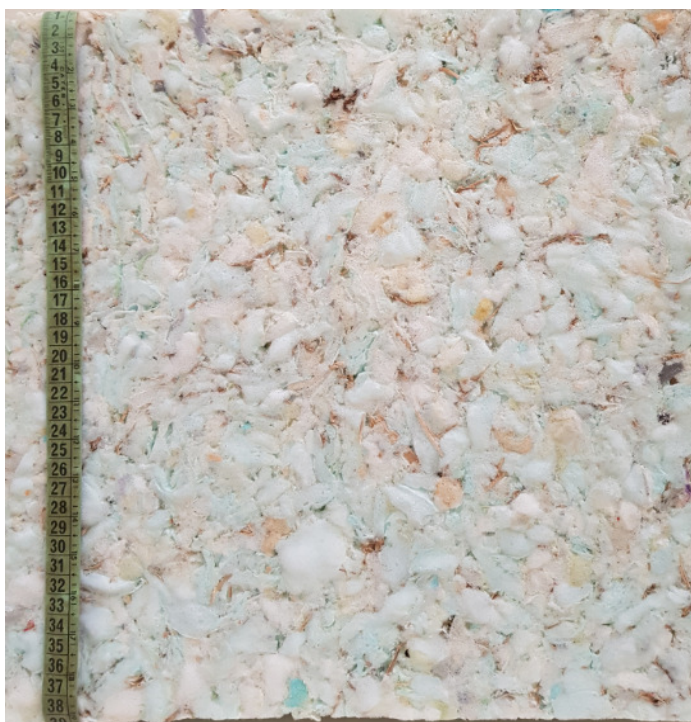
Figura 30 – AGFB 3- 20% de fibra e espuma flexível de PU
