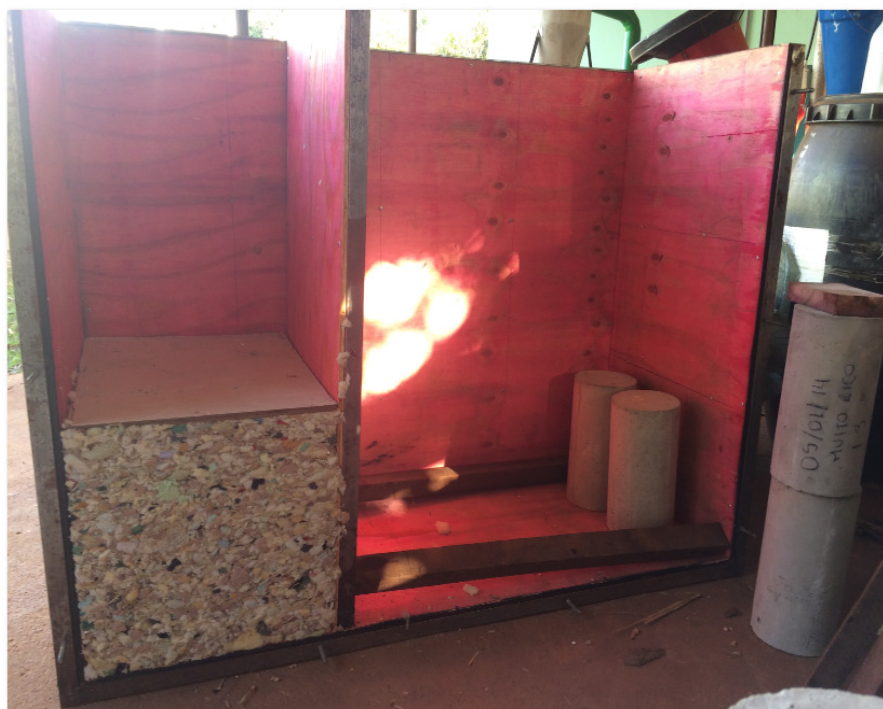
Figura 28 – Bloco de AGFB no molde e pesos padrão
