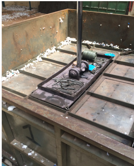
Figura 21 – Caixa moldadora e prensa
