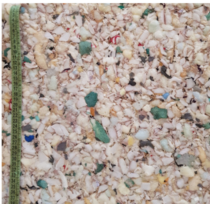
Figura 29 – AGFB 1- 20% de fibra, espuma flexível de PU e aparas têxteis
