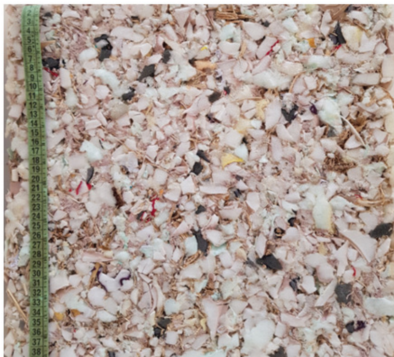
Figura 31 – AGFB 2- 40% de fibra, espuma flexível de PU e aparas têxteis
